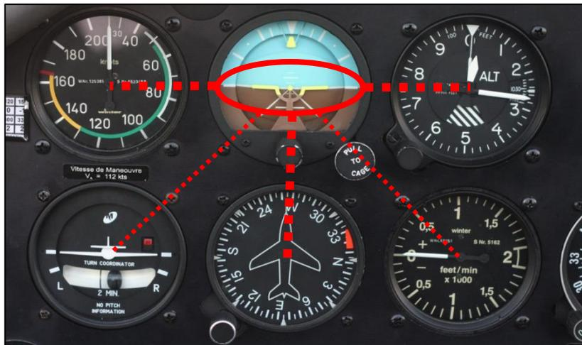
Exemple du circuit visuel aux instruments en montée :
